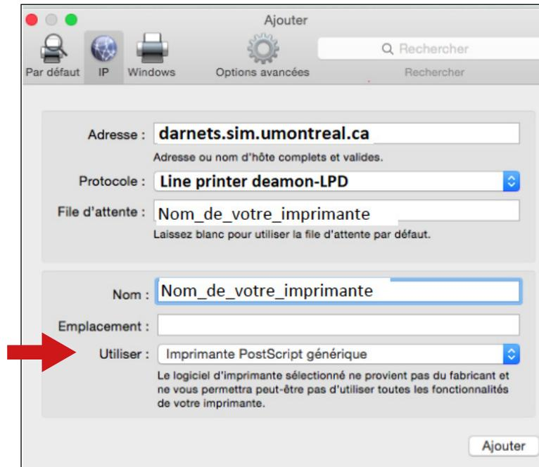
9) Dans le menu déroulant, sélectionner **sélectionnez le logiciel...**
